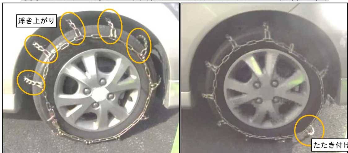
写真6. タイヤから浮き上がり、路面にたたき付けられるチェーン(速度30km/h)
