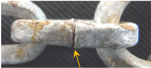
溶接不良箇所(隙間あり)
