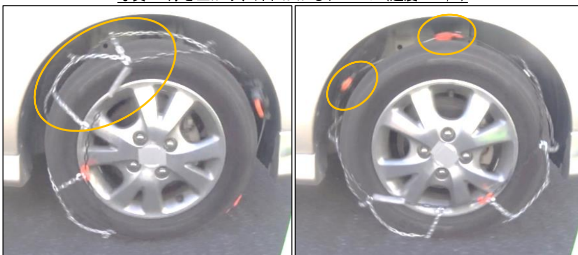
写真7. 浮き上がり、外れかかるチェーン(速度20km/h)
